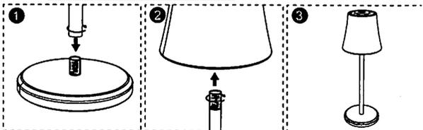
Schrauben Sie den Lichtmast mit Gewinde an den Sockel und den Lampenkopf.
